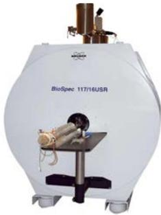
Biospec 117/16 型 11.7T超高场小动物磁共振成像系统及配套的软、硬件设施，可以实现小鼠、大鼠或其它小型动物的活体磁共振成像、脑功能成像(可兼容电生理、光遗传)、波谱实验以及杂核成像。
